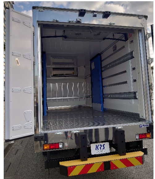
(-25°Cから+20°Cまであらゆる温度帯に対応の2室2エバ仕様で異温度配送も可能)
