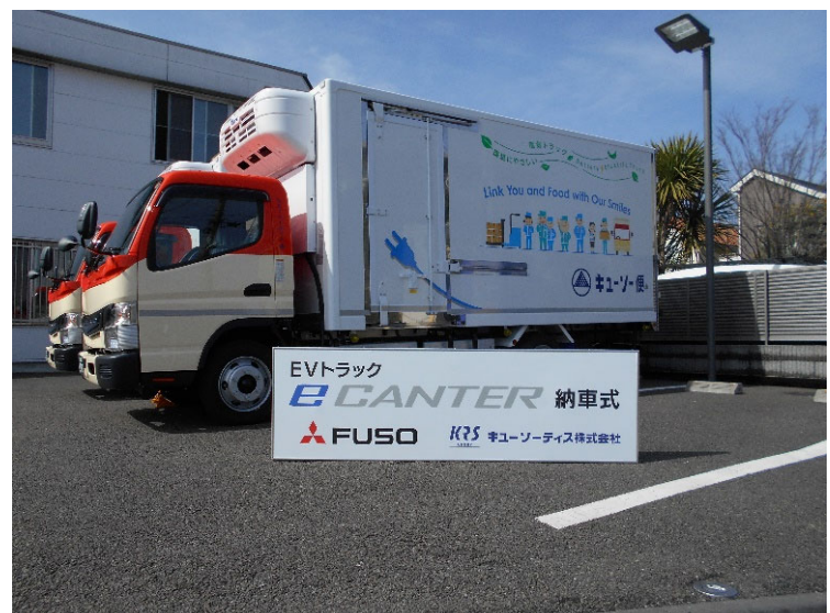
(-25°Cから+20°Cまであらゆる温度帯に対応の2室2エバ仕様で異温度配送も可能)
